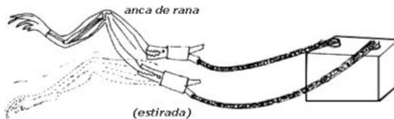
*Figura 2. Si los metales hierro y cobre se unen, el anca de la rana se contrae debido al paso de una corriente eléctrica.*
